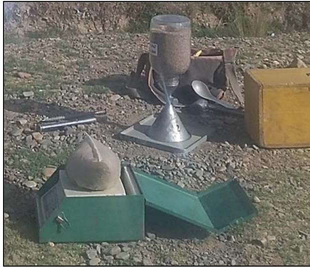
FOTOGRAFÍA F9 Ensayo de Densidad en Sitio Fuente: Elaboración propia
