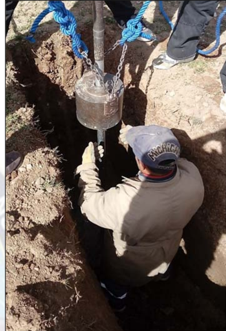
FOTOGRAFÍA F4 Ensayo de SPT - Parque Urbano Central del DISTRITO 6 Fuente: Elaboración propia
