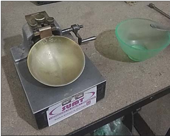
FOTOGRAFÍA F8 Ensayo de Límites de Atterberg Fuente: Elaboración propia
