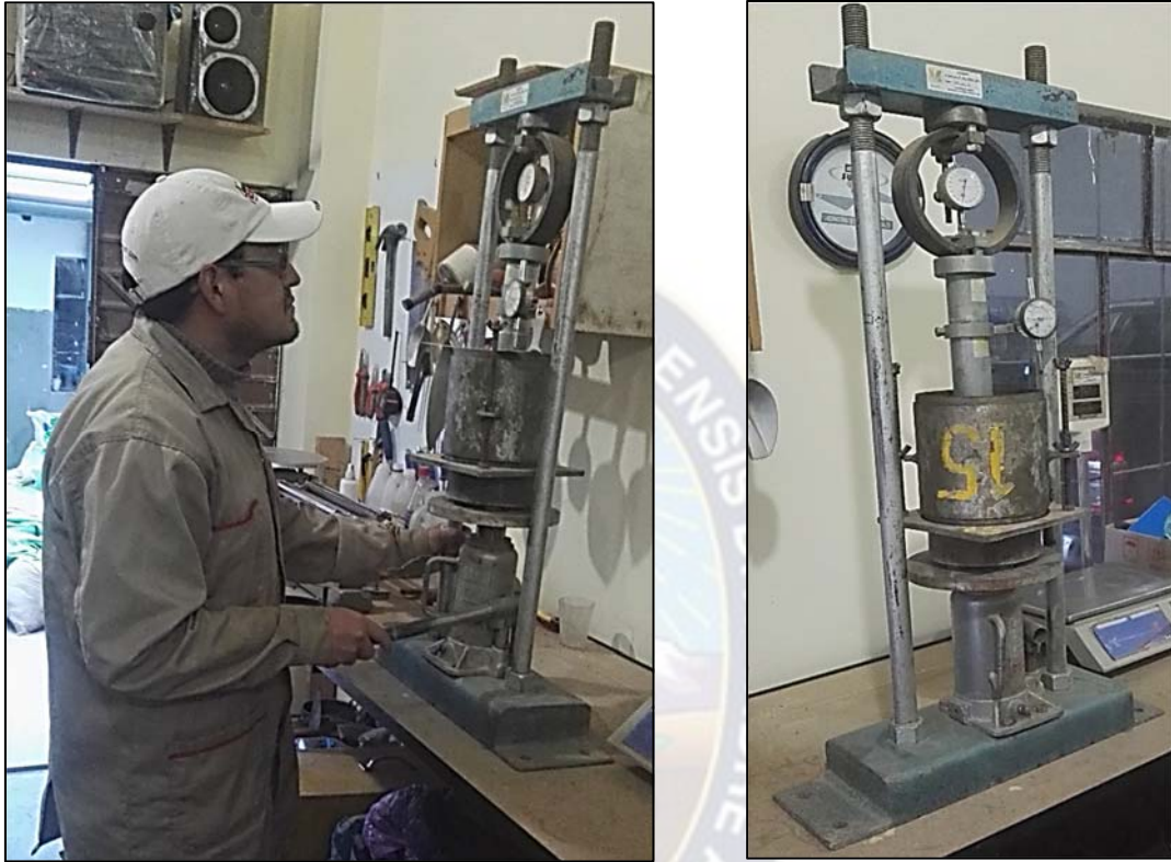
FOTOGRAFÍA F14 Ensayo de C.B.R. Fuente: Elaboración propia
