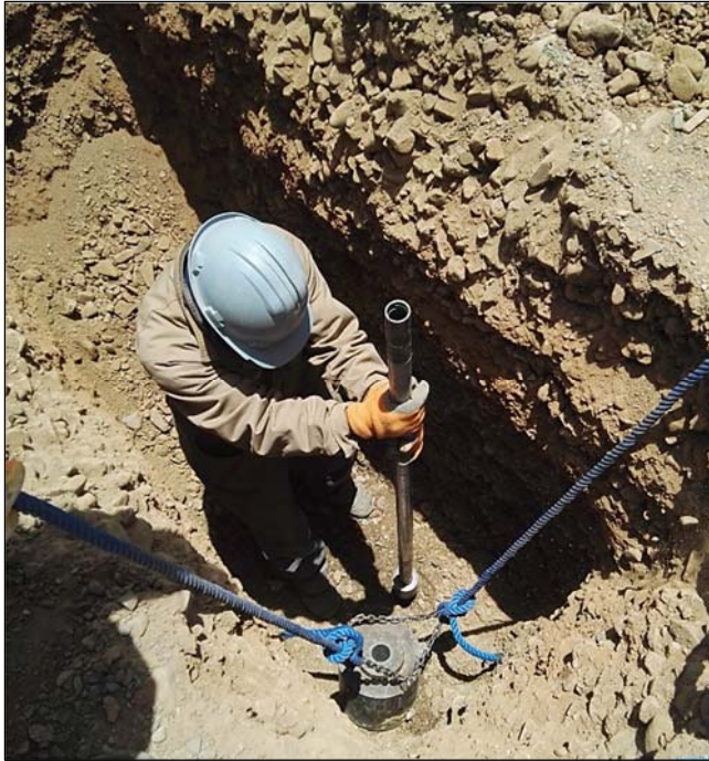
FOTOGRAFÍA F4 Ensayo de SPT - Parque Urbano Central del DISTRITO 6 Fuente: Elaboración propia
