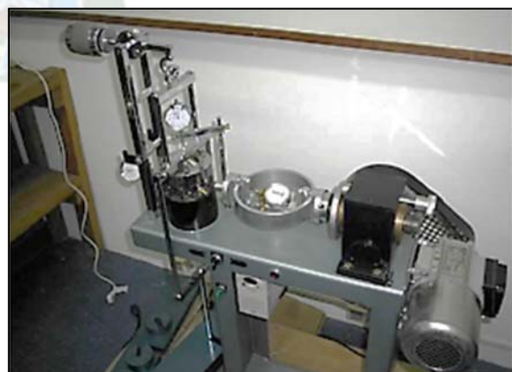
FOTOGRAFÍA F11 Ensayo de Corte Directo
