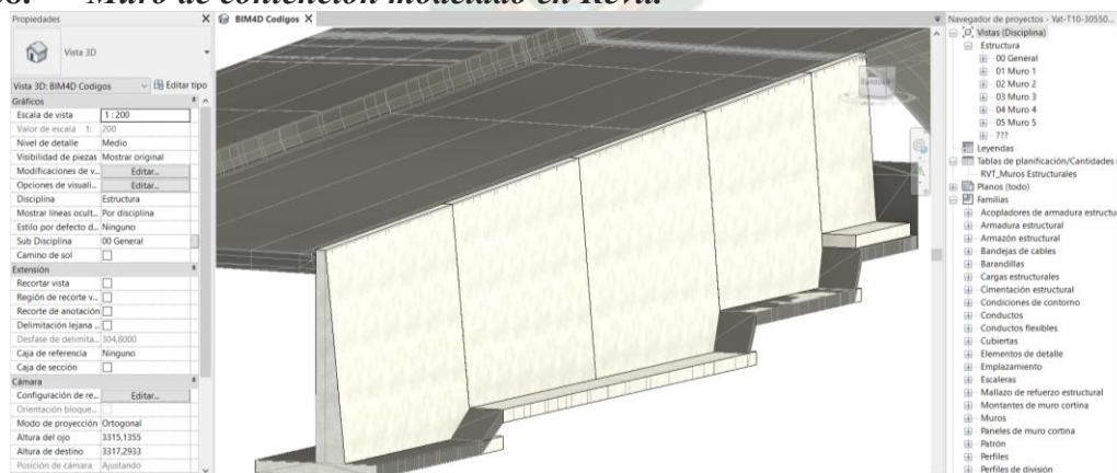
Figura 58. Muro de contención modelado en Revit.
