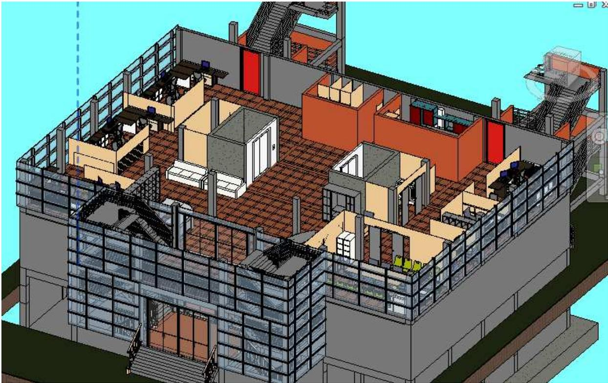
La figura muestra la vista isométrica de las oficinas con su respectiva entrada y salida de emergencia, también se observa la posición de los núcleos de ascensor.
