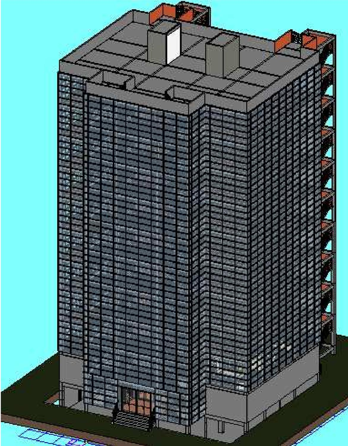
La figura muestra la vista isométrica del edificio de 10 pisos, el local comercial tiene muros de tabiquería, mientras que los muros destinados a oficinas tienen muros de vidrio.
