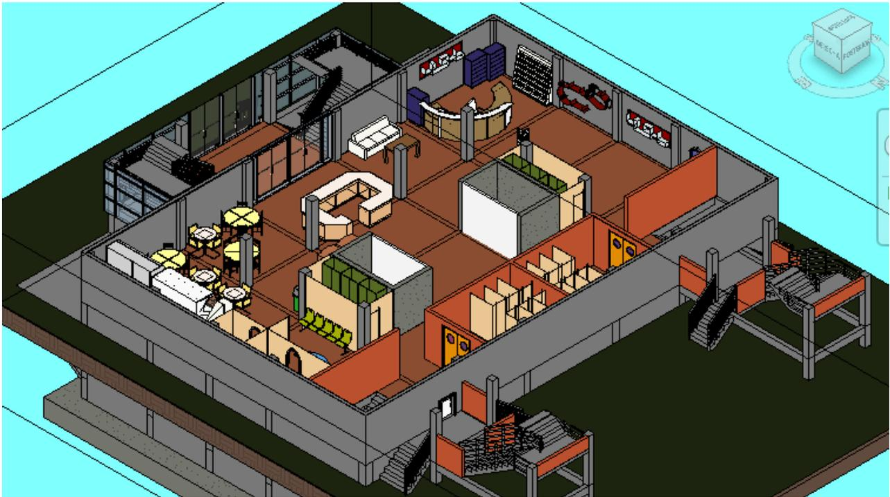
La figura muestra la vista isométrica del local comercial con su respectiva entrada y salida de emergencia, también se observa la posición de los núcleos de ascensor.
