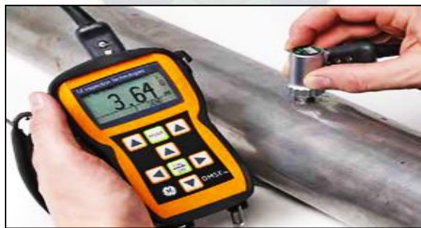
Figura 3-1 Equipo ultrasónico (DM5E).
