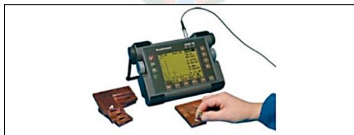
Figura 3-9 Equipo ultrasónico con imagen (barrido tipo A).
