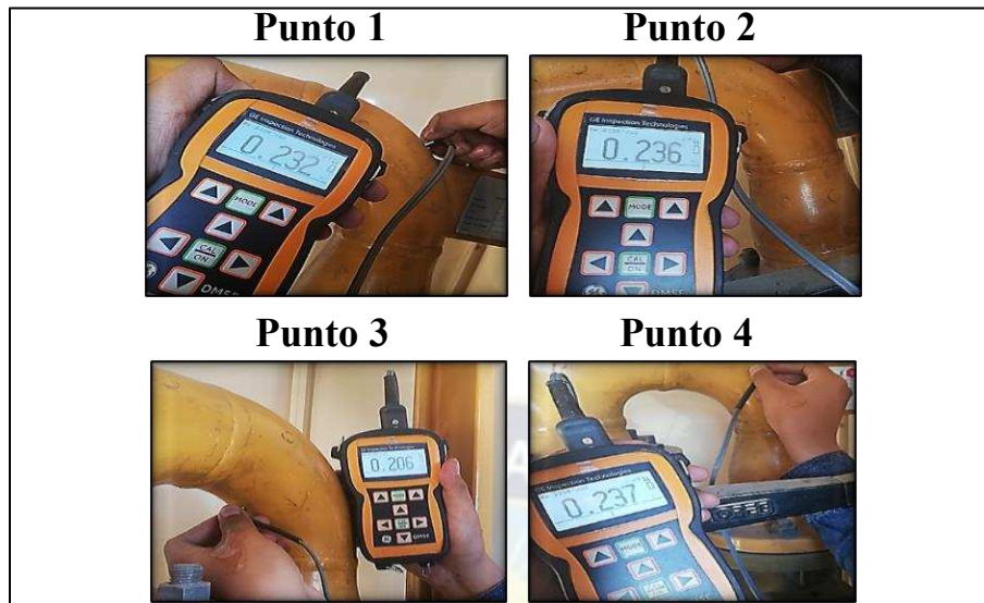
Figura 3-16 Caso práctico de los puntos de medición en codos.
