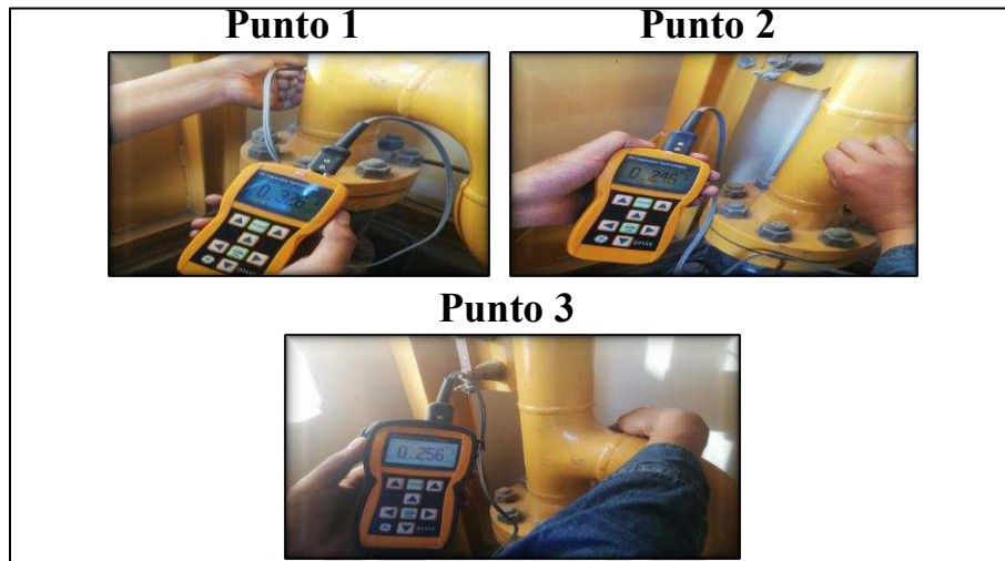
Figura 3-18 Caso práctico de los puntos de medición en tee.
