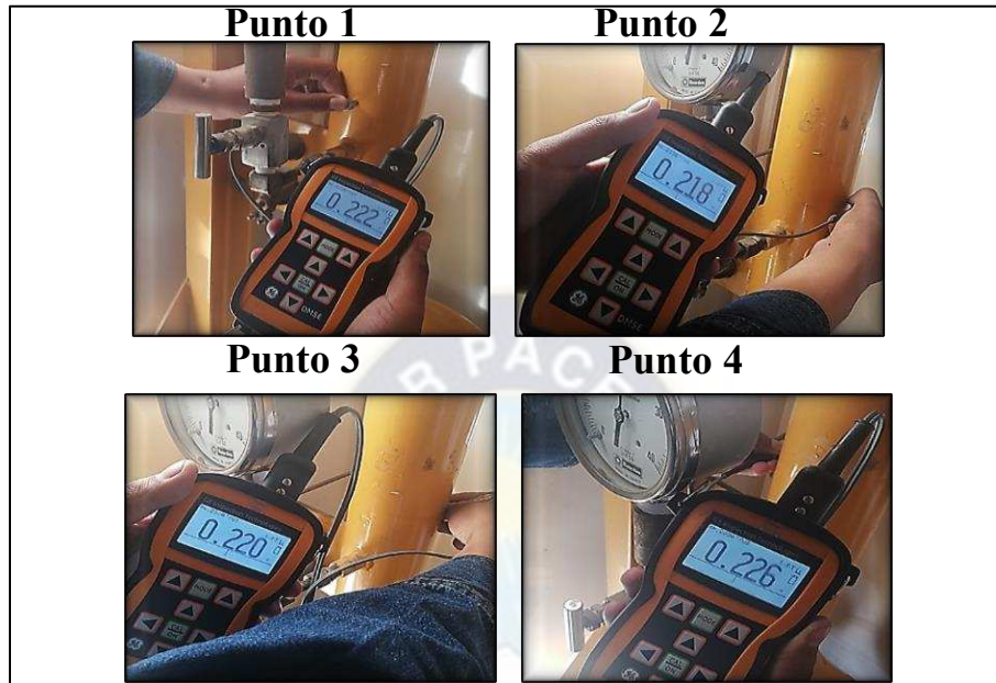
Figura 3-14 Caso práctico de los puntos de medición en tubería.
