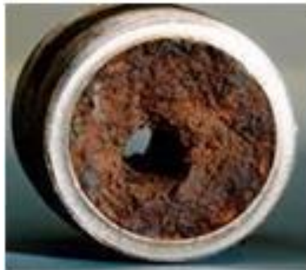
FIGURA 2.5 Deposición de parafina por presencia de materias extrañas
