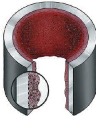
FIGURA 2.6 Residuos duros y depósitos densos de parafina fundida
