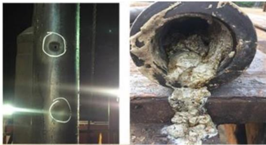
FIGURA 2.11 Deposición de parafinas en bombeo hidráulico
