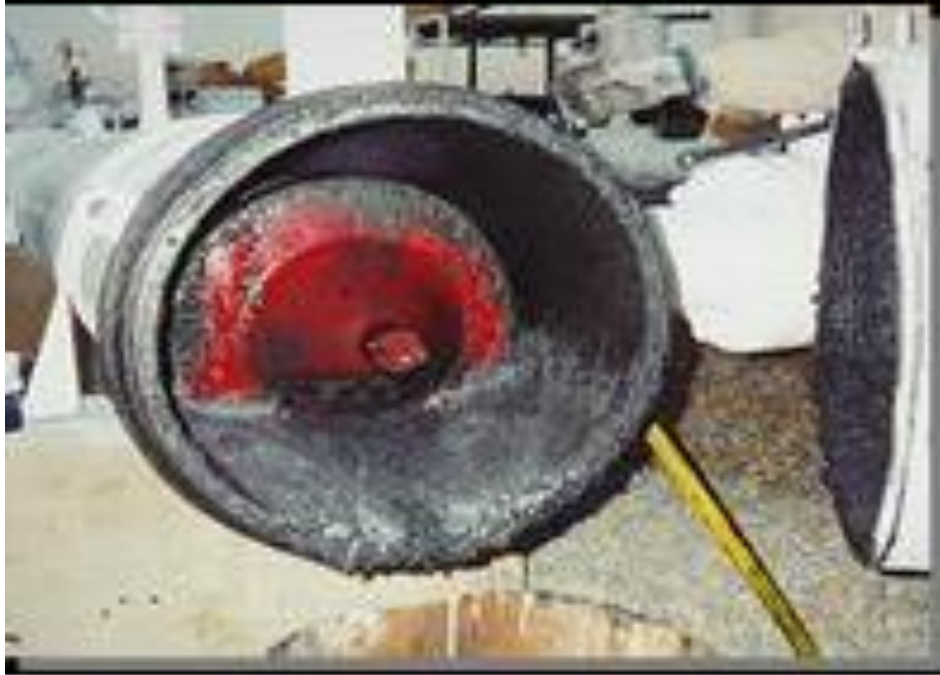
FIGURA 2.3 Hidrocarburos parafínicos que se precipitan y adhieren al liner
