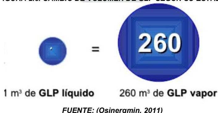
Un litro de líquido se transforma en 272,6 litros de gas para el propano y 237,8 litros de gas para el butano. No tiene color en su estado líquido es transparente similar al agua, no es tóxico, pero no se recomienda respirarlo por mucho tiempo debido a que desplaza el oxígeno.
