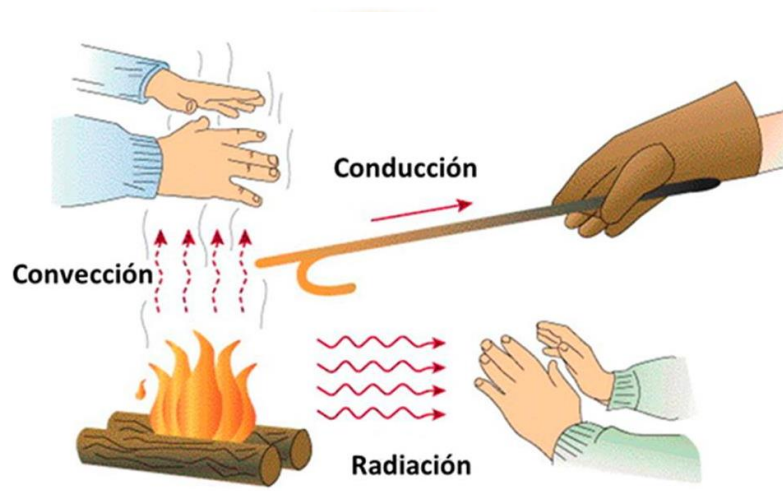
Figura 2.10: Mecanismos de transferencia de calor.
