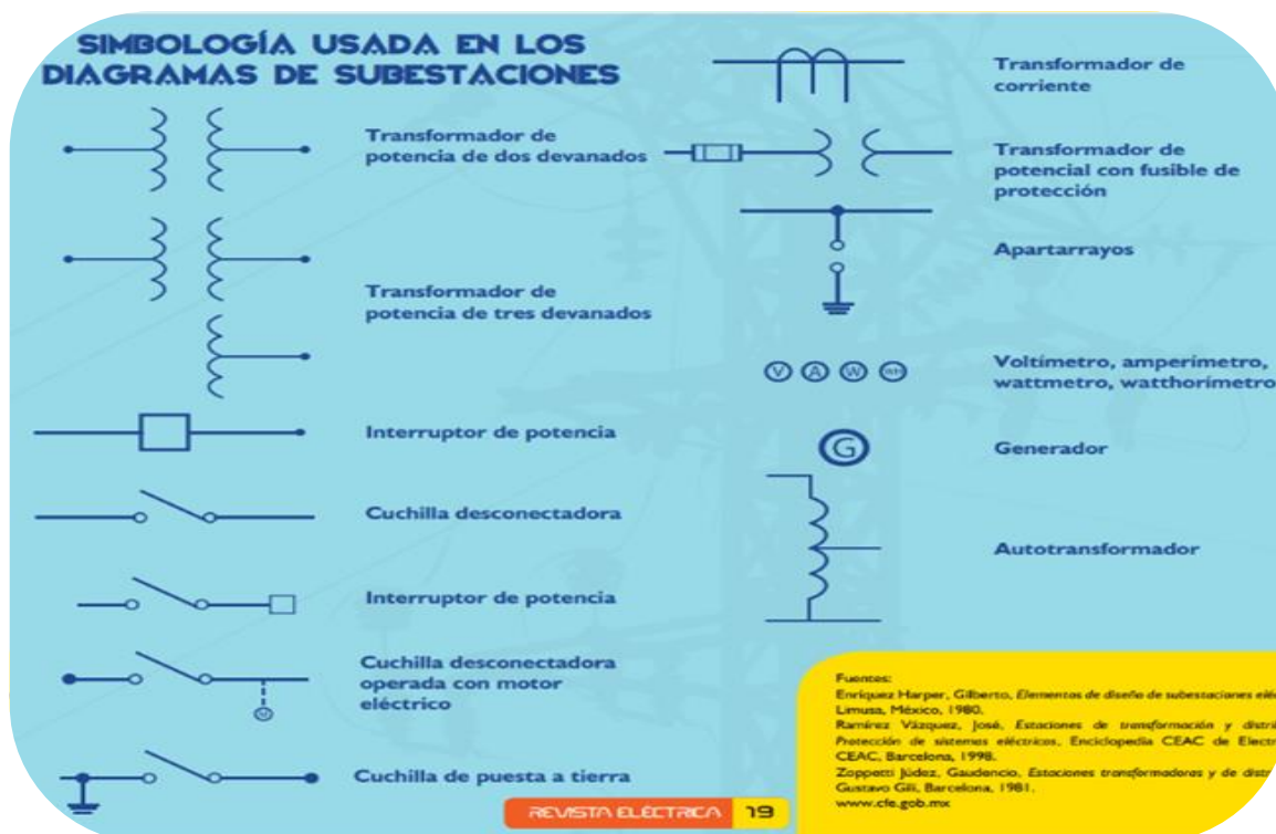
Figura 2.29: Simbología usada en los diagramas de Subestaciones.
