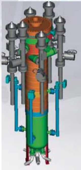
Figura 4.3 Separador central con los 6 separadores supersónicos
