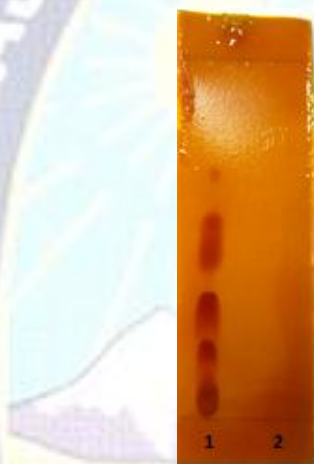
Figura 10 Placa de TLC revelada con Dragendorff. 1) Prueba positiva de alcaloides para el extracto en H_2SO_4 2%. 2) Prueba negativa para alcaloides en el remanente redisoluto en EtOH.
