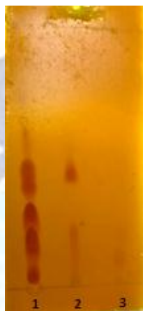
Figura 11. Placa de TLC revelada con Dragendorff de las tres porciones de AcOEt de la extracción líquido-líquido. 1) Presencia de todos los alcaloides de la muestra. 2) presencia de al menos dos alcaloides. 3) no se detecta presencia de alcaloides.
