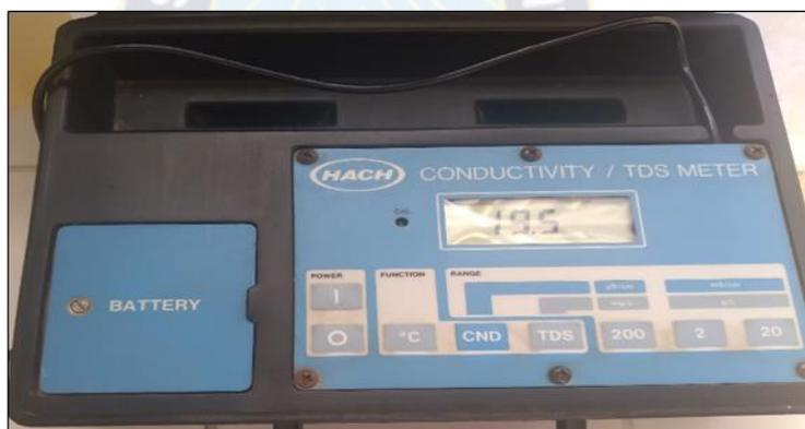
Figura 23. Equipo portátil HACH conductivity/TDS Meter
