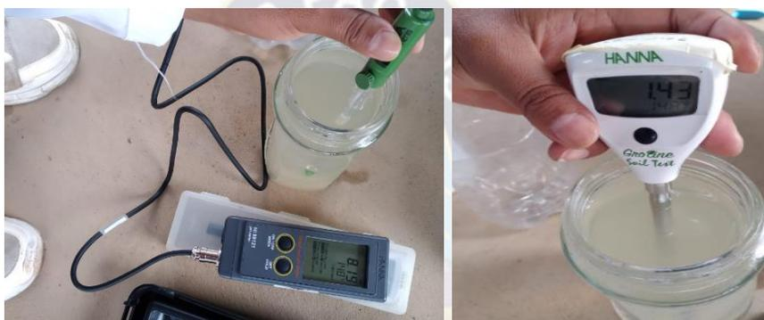
**Figura 29.** Toma de datos *in situ*, temperatura, pH, conductividad y de muestras de agua del afluente y efluente de la PTAR Viacha.
