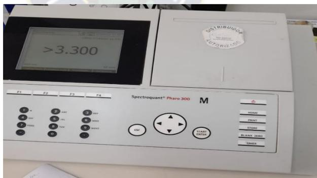
**Figura 25.** Espectrofotómetro UV/VIS - Spectroquant® Pharo 300, IIQ-UMSA
