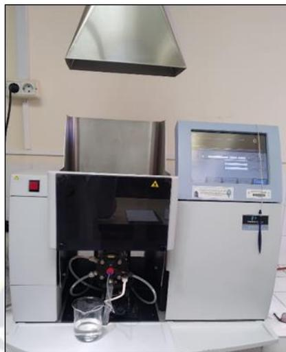
**Figura 24.** Espectrómetro de Absorción Atómica – Perkin Elmer Analyst 200. IIQ – UMSA
