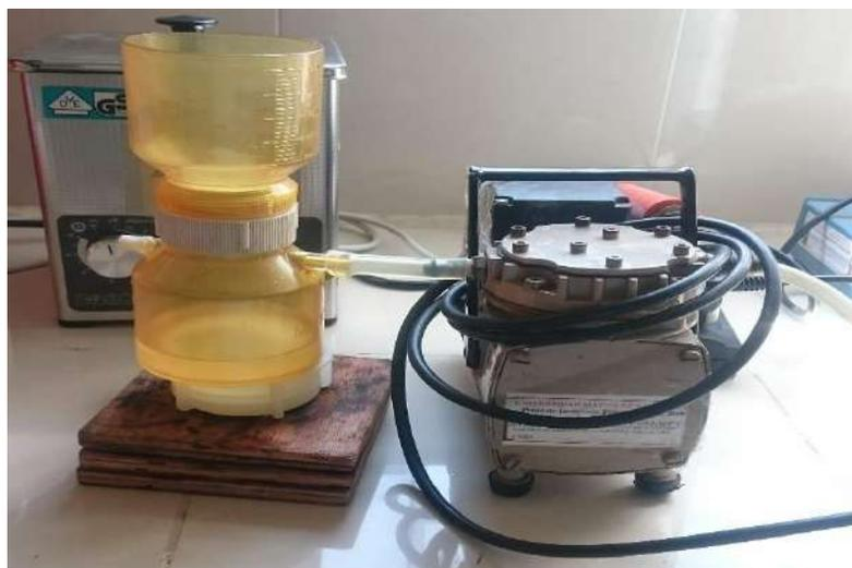
**Figura 11** Filtración de la muestra para análisis de sulfatos con la ayuda de una bomba de vacío.
