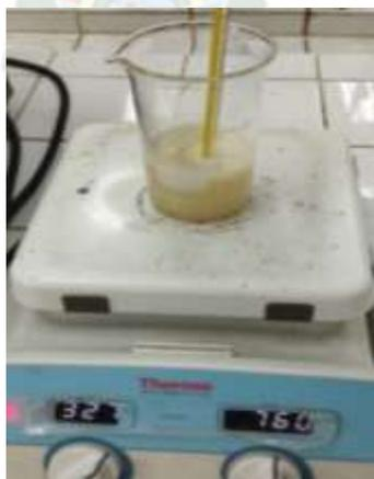
*Figura 19. Hidrólisis en la plancha de calentamiento*
