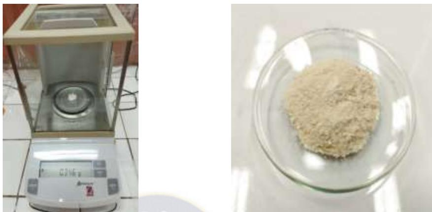
Figura 24. Pesada de la Pectina seca (izq). Pectina seca y molida (der).
