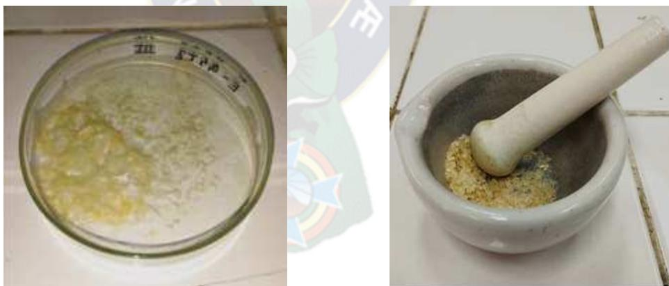
*Figura 23. Pectina seca en caja petri (izq). Molienda de la pectina en mortero (der).*
