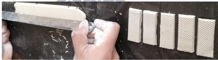
Figura 20 Conformado de las probetas cerámicas
