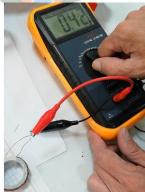
Figura 61 Ensayo de autoinducción
