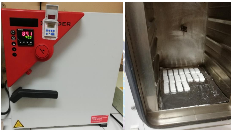
Figura 22 Secado de las probetas en estufa hasta 100^{\circ}\text{C}
