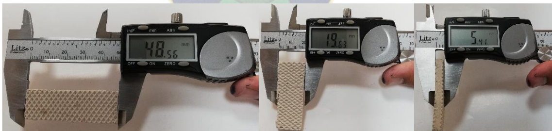
Figura 21 Medición de las dimensiones de la probeta
