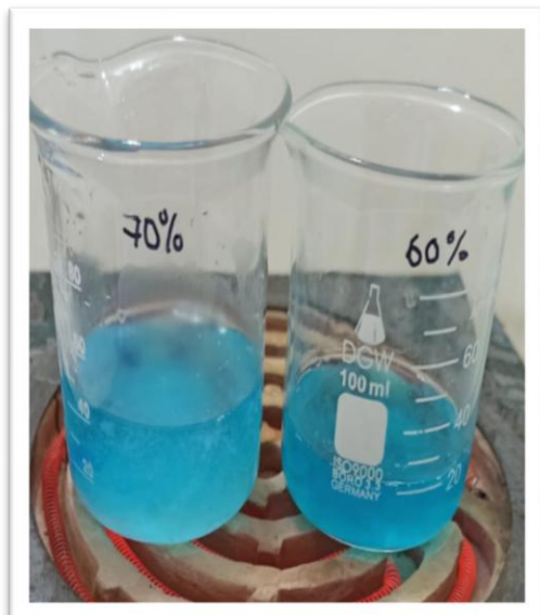
Figura 25 Pruebas de Fehling
