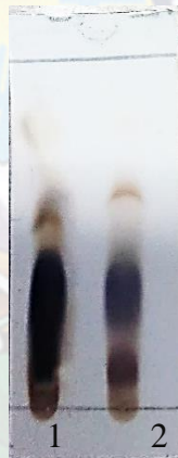
Figura 25: Placa TLC de 1) Extracto crudo de AcOEt y 2) Fracción éter de petróleo (20-40): AcOEt 1:1. Fuente: Elaboración propia
