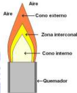
Figura 11. Regiones de una llama, la región interconal es la de mayor temperatura y permite mayor reproducibilidad de análisis
