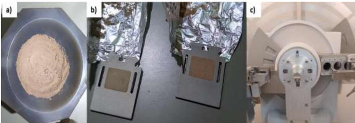
**Figura 12.** Análisis de difracción de Rayos X a) pulverización de la muestras de sedimento, b) Muestras introducidas en portamuestra de acero inoxidable y c) muestra expuesta a los Rayos
