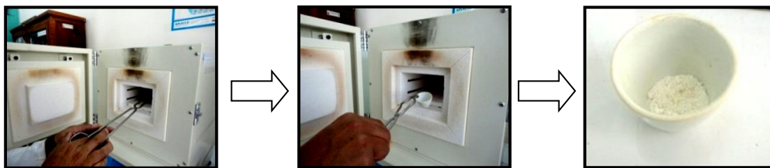
Figura 19. Desorción por incineración ALU/Ulexita a 300oC (negativa)
