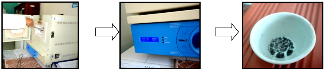
Figura 18. Desorción por incineración ALU/Ulexita a 600oC (negativa)
