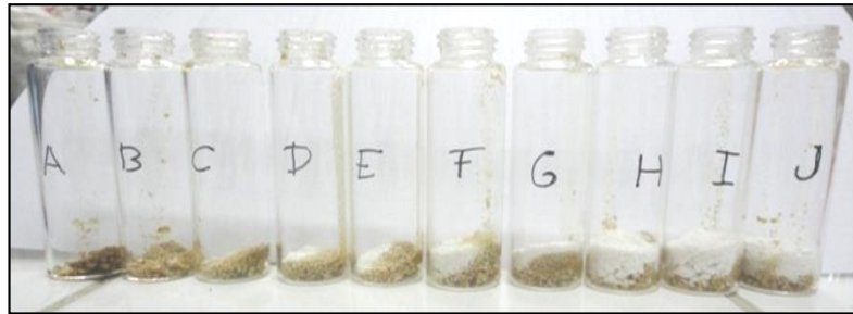
Figura 29. Adsorción Aceite lubricante usado sobre ulexita
