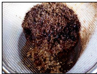
Figura 8. Adsorción Luffa cilíndrica y petróleo crudo Fuente: Velandia 2017
