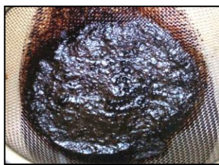
Figura 9. Adsorción bagazo de caña de azúcar y petróleo crudo Fuente: Velandia 2017
