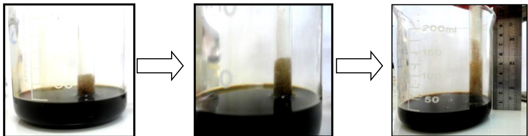
Figura 14. Capilaridad del aceite lubricante usado sobre ulexita
