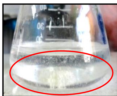
Figura 22. Desorción ALU/Ulexita empleando agua a 80°C constante (positivo)
