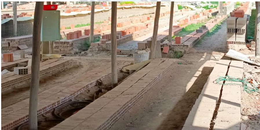
Ilustración 3. 10 LADRILLERA EMANUEL: ETAPA DE SECADO
