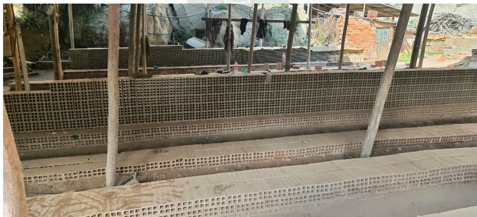
Ilustración 3. 11 LADRILLERA EMANUEL: ETAPA DE SECADO EN PLAYERAS
