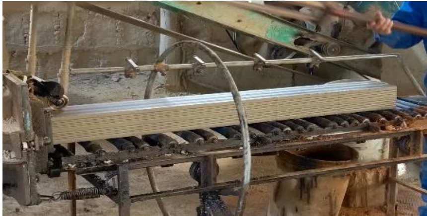
Ilustración 3. 8 LADRILLERA EMANUEL: PROCESO DE CORTADO
