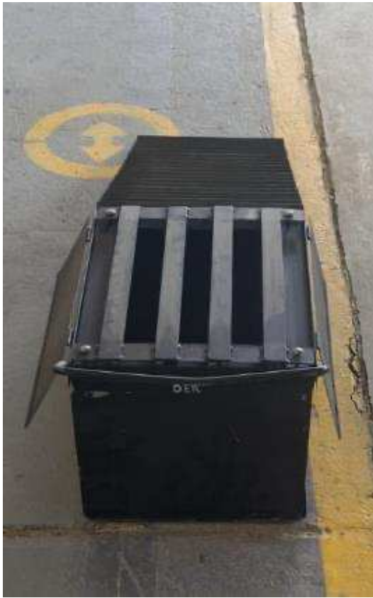
a) Rampa derecha con barras de metal y con planchas laterales
