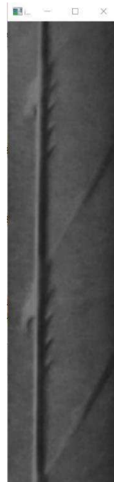
b) Aplicación del filtro Gaussiano de imagen neumático derecho de blanco y negro para suavizar la imagen.
