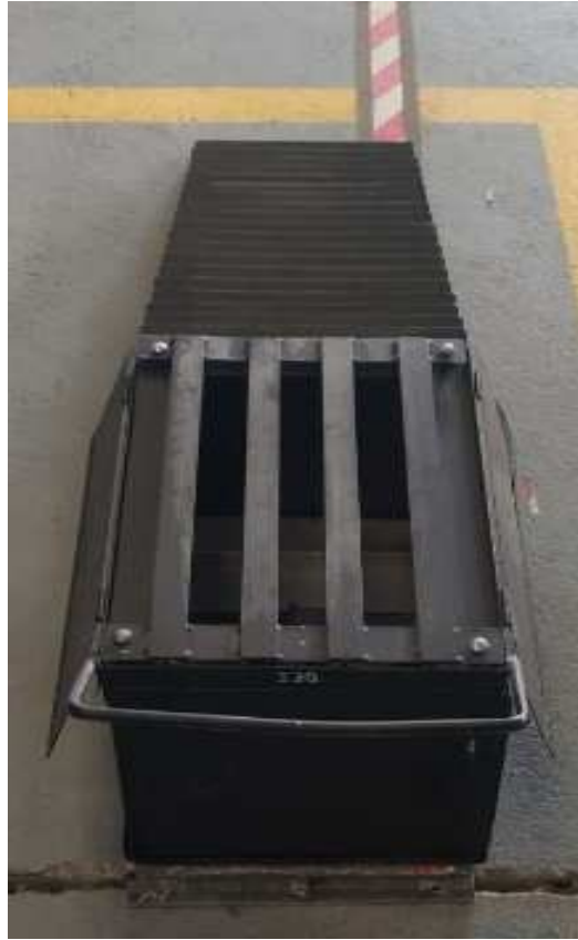
b) Rampa Izquierda con barras de metal y con planchas laterales
