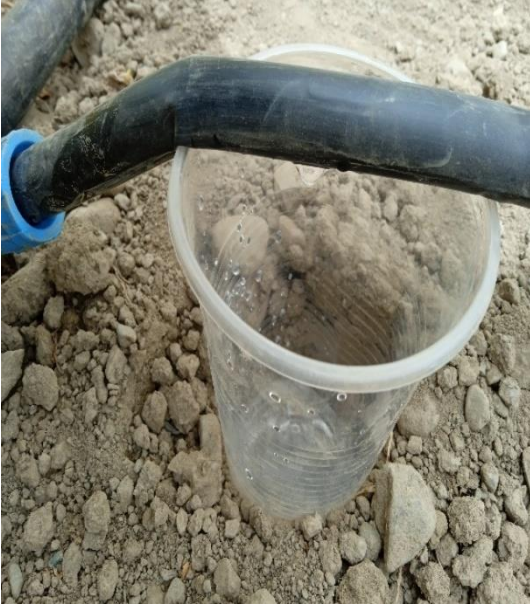
Fotografía 13. Vaso de recolección para la prueba de coeficiente de uniformidad
