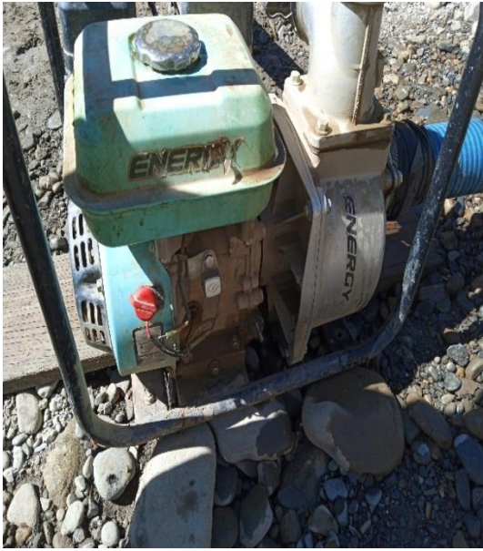
Fotografía 5. Motobomba de 5 HPs propiedad de la casa hogar Santa Aquilina
