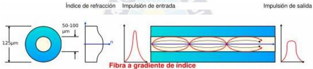
Figura 2.8 Propagación de la luz en la fibra óptica multimodo índice gradual Fuente: Wirth A. Fibras ópticas: Teoría e Práctica
