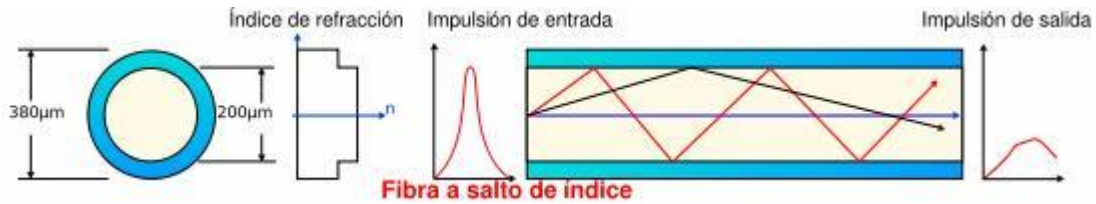
Figura 2.7 Propagación de la luz en la fibra óptica multimodo índice escalonado Fuente: Wirth A. Fibras ópticas: Teoría e Práctica
