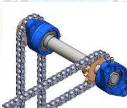
Figura 2-41. Diseño de eje 2 con piñones y chumaceras
