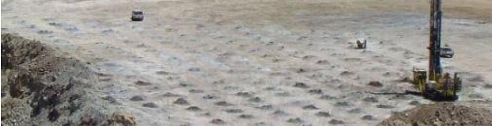
El proceso de minado comienza con la perforación de “pozos de voladura” que siguen un reticulado de 7 a 10 metros, dependiendo del tipo exacto de roca que se debe extraer en cada lugar.
