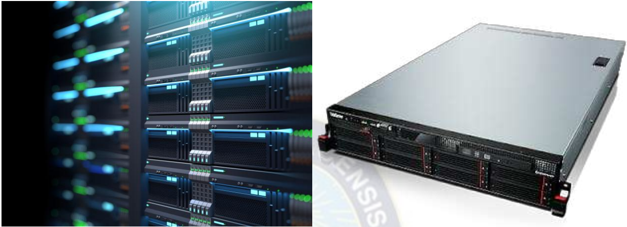
Figura 2. Servidor tipo RACK. (LAGE, 2019)
