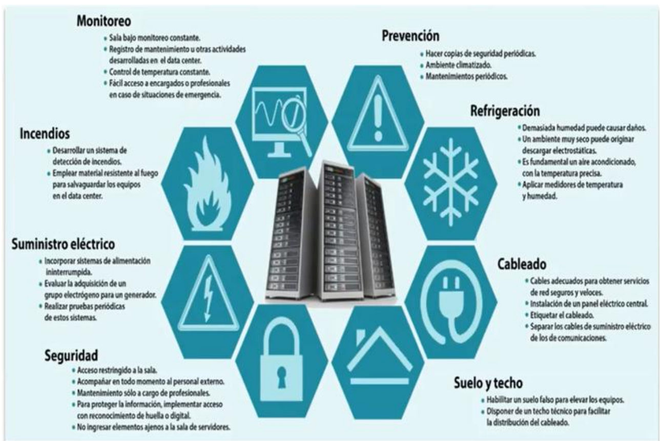
Figura 38. Infraestructura Crítica y Soporte Operativo.
