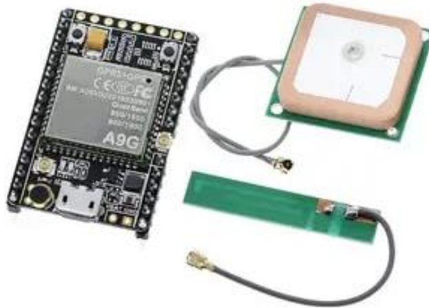
Figura 16. Módulo A9G con sus antenas GSM y GPS. Fuente: (Naylamp Mechatronics, 2023)
