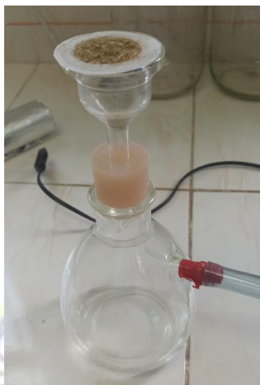
Figura 35 Equipo de Filtración
