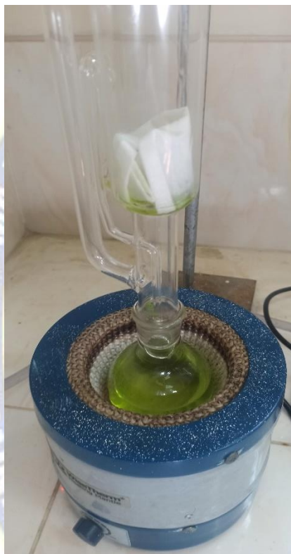
Figura 45 Extracción Soxleth de microalga rica en betacaroteno
