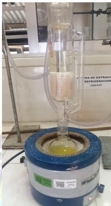
Figura 46 Extracción Soxleth de microalga rica en Astaxantina
