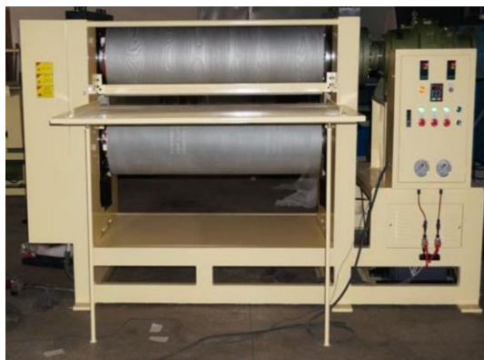
Ilustración 32. Máquina de grabado en alto relieve
