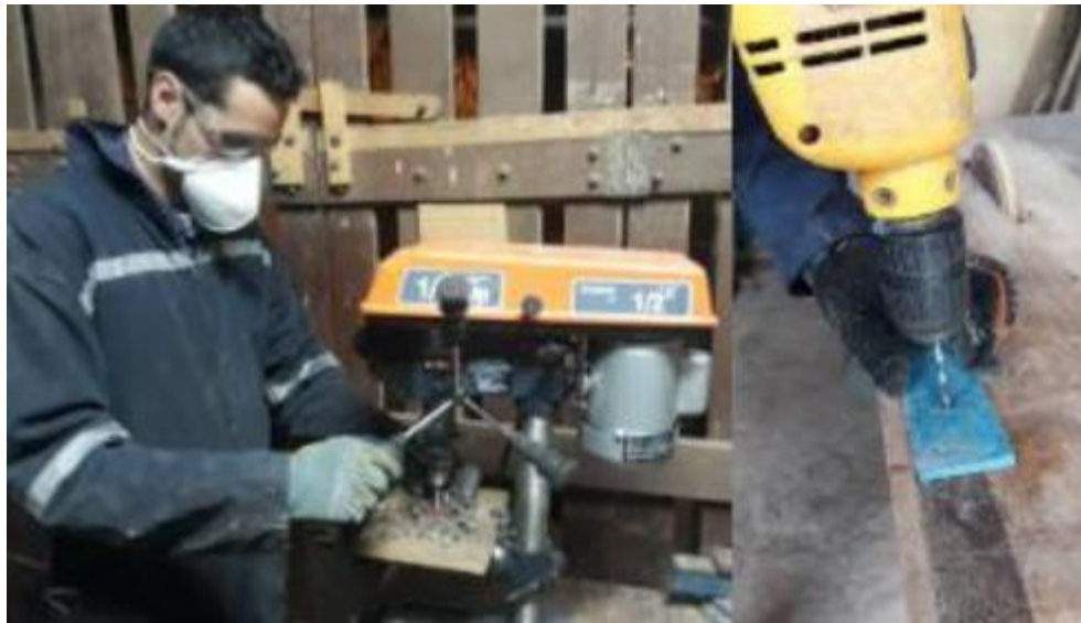
Ilustración 17. Perforación del material
