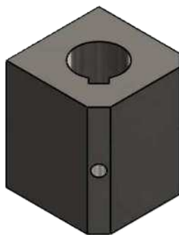
VISTA ISOMÉTRICA CUBO DE SOSTENCIÓN PALETAS
