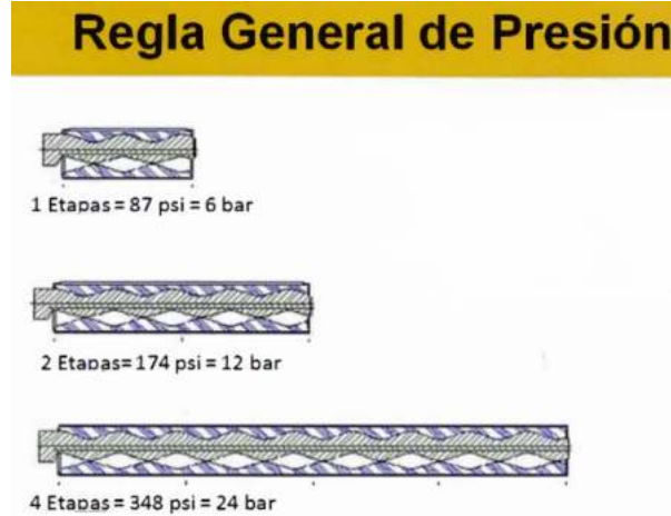
Figura 3.51 Regla de la presión para una bomba BCP
