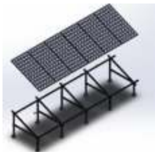
Figura 4.1 Montaje de los paneles fotovoltaicos.
