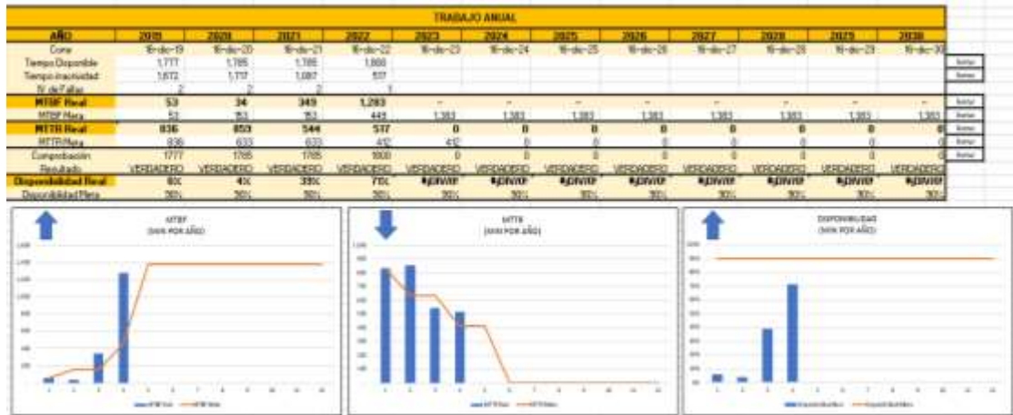
Ilustración 49. INDICADORES DE MANTENIMIENTO MTTR, MTBF Y DISPONIBILIDAD DE EQUIPO BALANCEADOR DE RUEDAS
