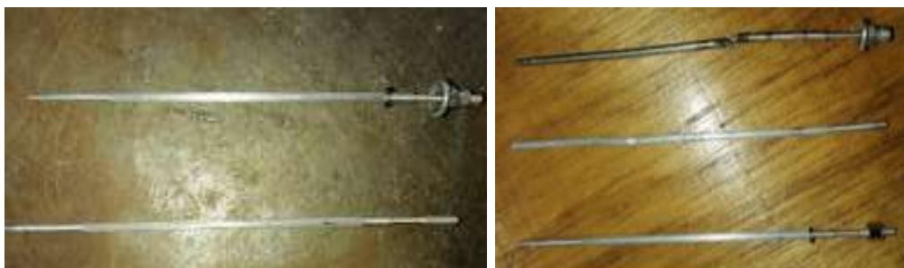
ANEXO 13 FABRICACIÓN DE VARILLA DE ALTA (UBICADA EN CARBURADOR DEL MOTORIZADO) DEL VEHÍCULO TOYOTA LAND CRUISER – PRADO
