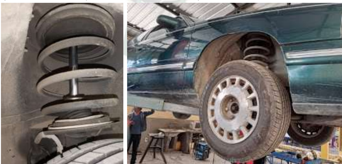
Ilustración 88. CAMBIO DE REPUESTOS DE SUSPENSIÓN TRASERA Fuente: Instituto de Investigaciones Mecánicas y Electromecánica
