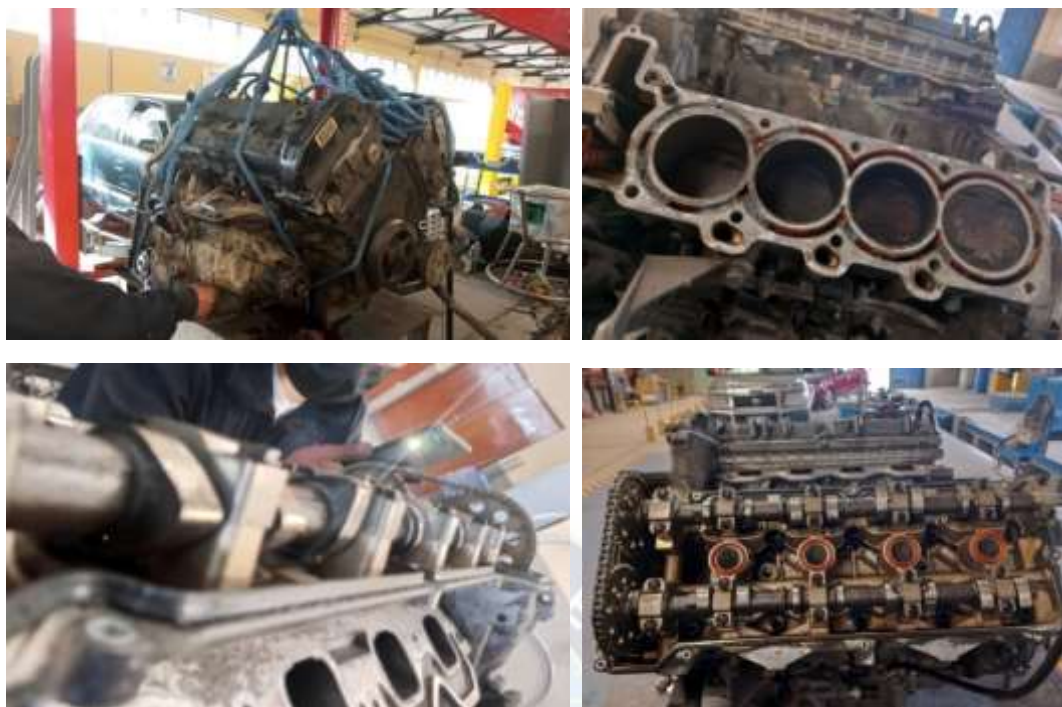
Ilustración 88. REPARACIÓN Y CAMBIO DE EMPAQUETADURA DEL MOTOR
