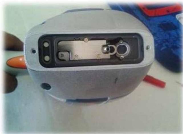
**Figura 10.** Equipo portátil Fluorescencia de rayos X- ED
