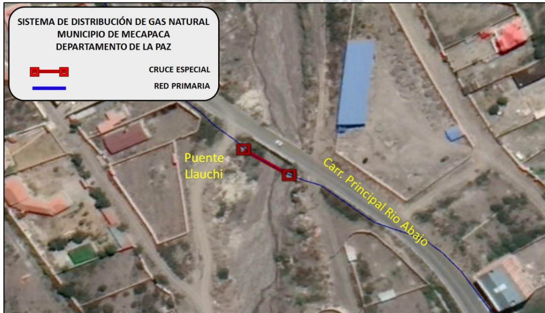
Figura 27. Cruce de río -Puente Llauchi
