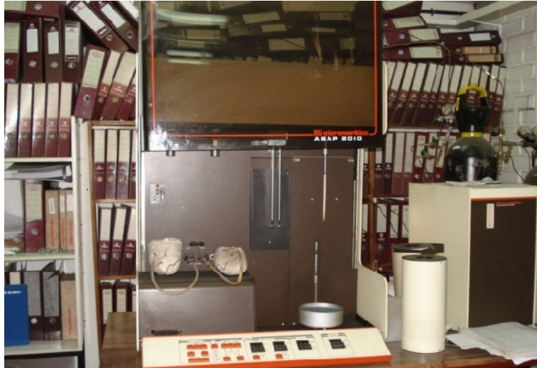
Figura No 2.4. Equipo de fisisorción de nitrógeno MICROMETRICS ASAP 2010 Usado para determinar la superficie BET, volumen y tamaño de poro de las muestras.
