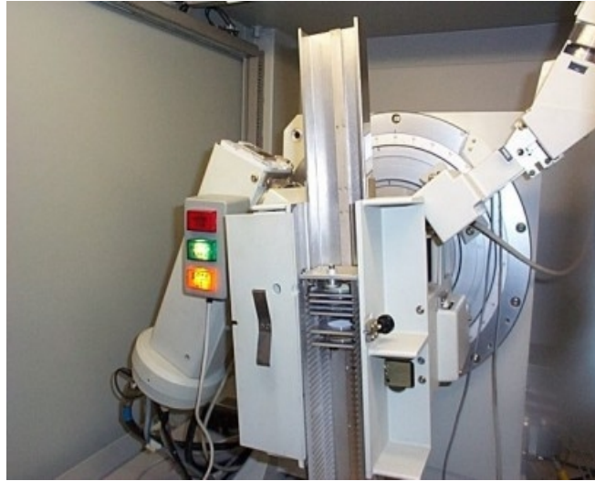
Figura No 2.5. Equipo Difractómetro Siemens D-5000, usado para determinar la estructura de los materiales
