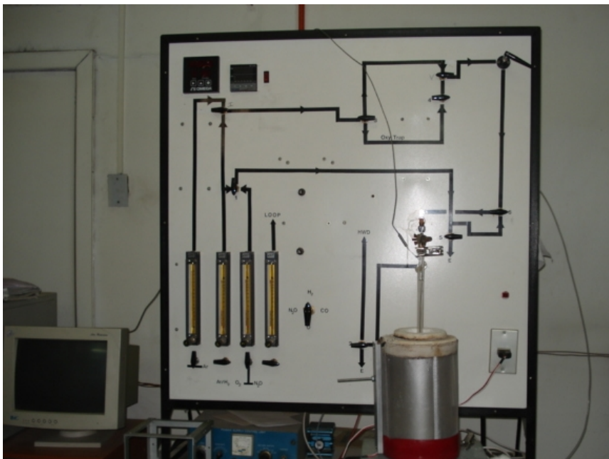
Figura No 2.8. Sistema aplicado para la determinación de la Reducción a Temperatura Programada de metales con flujo de hidrogeno ( H_2 -TPR).
