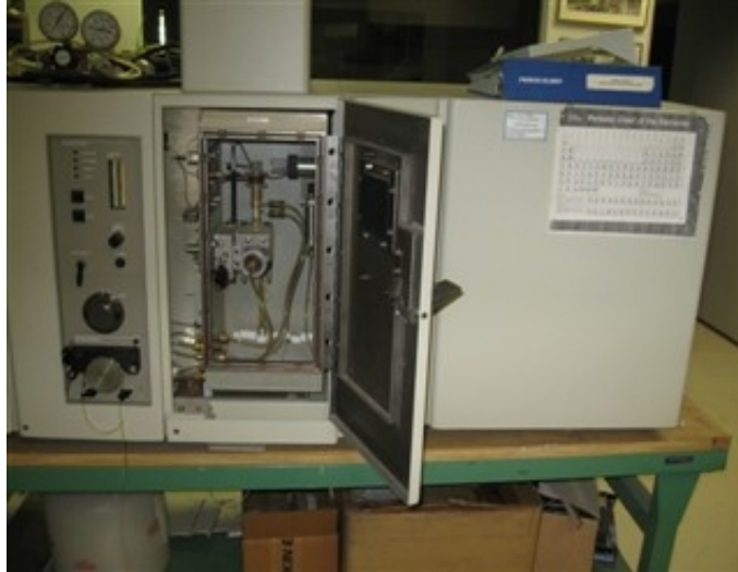
Figura No 2.3. Equipo de Plasma acoplado por inducción Perkin Elmer aplicado para el análisis de la composición de las muestras.
