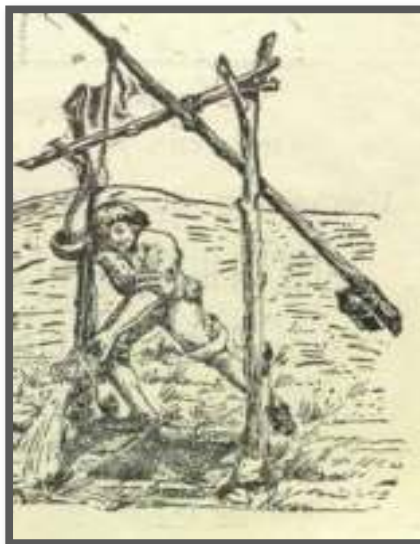
Figura 1.3: Utilización del contrapeso en el shadoof para reducir el esfuerzo en elevaciones.
