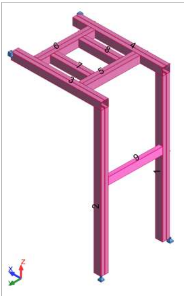
Figura 2.10: Estructura soporte principal del montacarga
