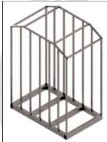
Figura 2.4: Cabina del montaCARGA
