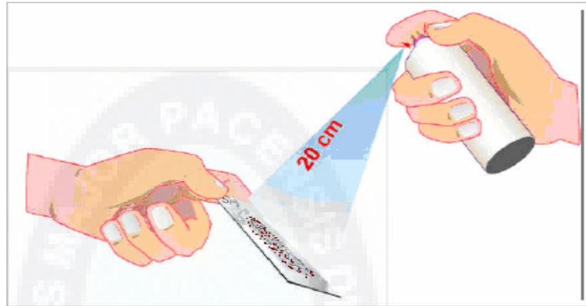
Figura 34. La Fijación de revestimiento aplicada a una distancia aproximada de 20-30cm entre la lámina y el atomizador de manera uniforme.
