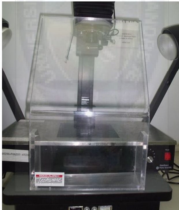
Transiluminador de luz UV. Para poder visualizar el ADN en los geles de agarosa
