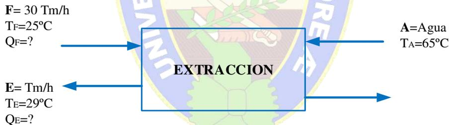
Balance global de energía para la extracción:  $Q_F + Q_A = Q_E + Q_B$  (4)
