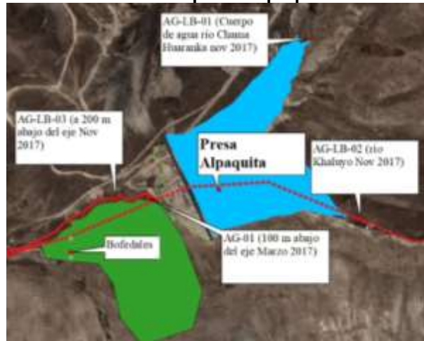
Figura 38. Puntos de muestreo realizado en la etapa de elaboración del diseño final de la presa Alpaquita
