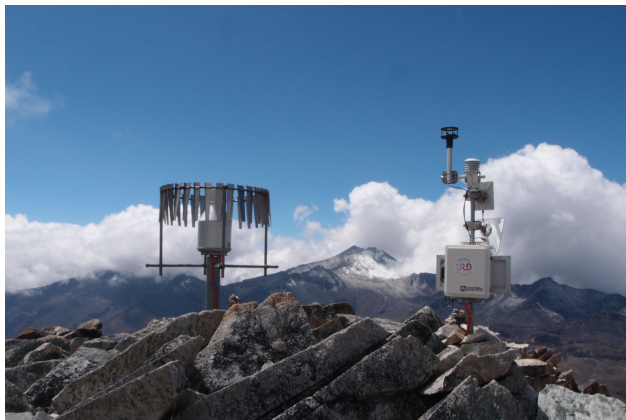
Figura 5.5: Estación de Campo Roca: Sistema de adquisición de datos, CR800 de Campbell Scientific; Temperatura y Humedad Relativa del aire, CS215 de Campbell Scientific; velocidad y dirección del viento, Windsonic de Gill; pluviómetro, T200B de Geonor. Fuente: Romain Biron
