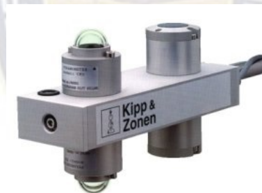
Figura 5.11: Radiómetro Kipp & Zonen, modelo CNR1. Fuente: Francou et al. (2004a)
