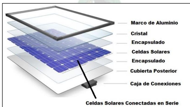
Fig 35. Partes del panel Fotovoltaico
