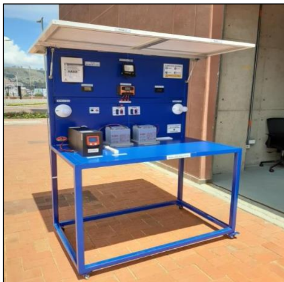
Fig 11. Ilustración de banco de pruebas fotovoltaico
