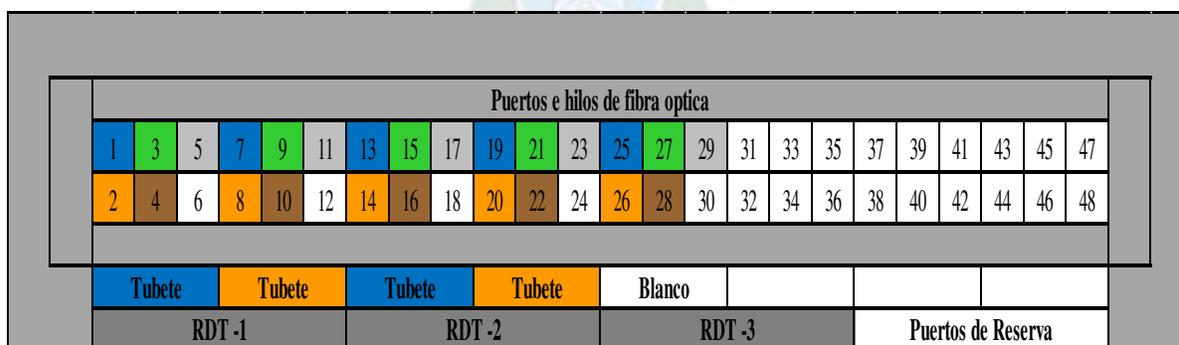
Figura 3.7.ODF con la distribución de buffer e hilos de FO
