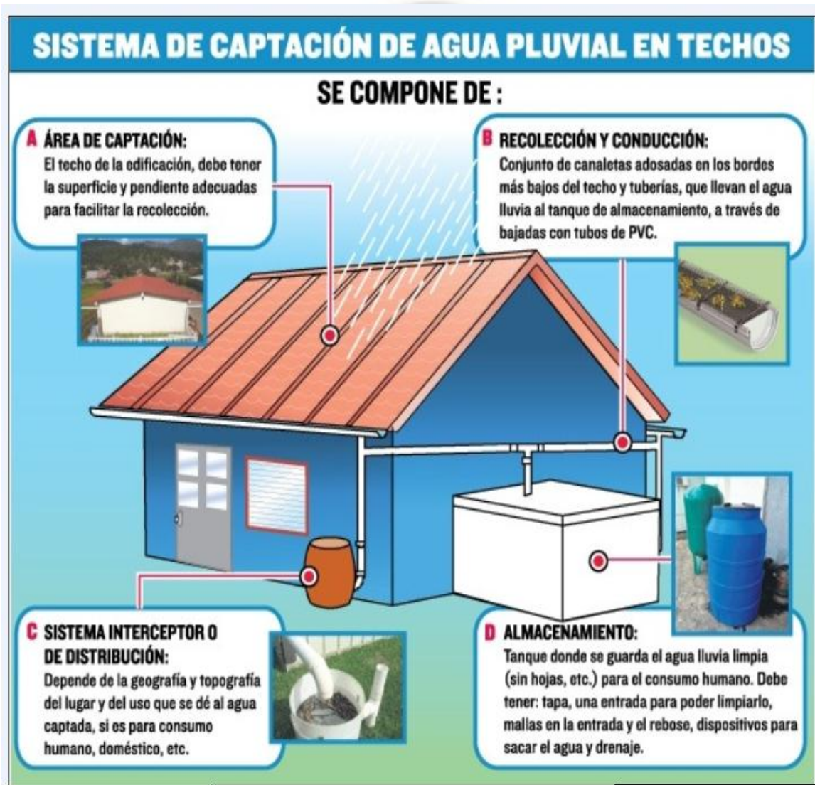
Figura 14. Sistema de captación de agua de lluvia
