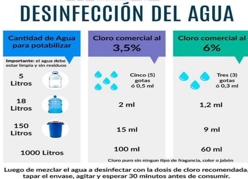
Figura 12. Desinfección del agua
