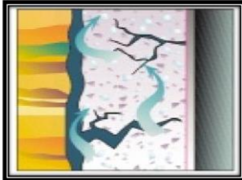
Fig. 2.23 “Problemas de cementación Contracción excesiva del cemento”
