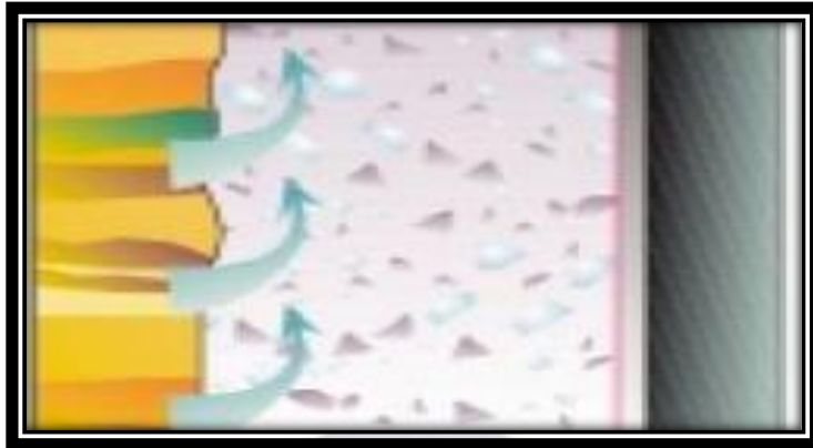
Fig. 2.18 “Problemas de cementación densidad errónea”
