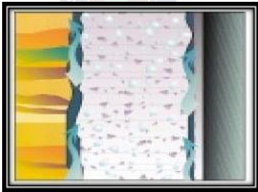
Fig. 2.26 “Problemas de cementación Adherencia interfacial deficiente (micro anillos)”
