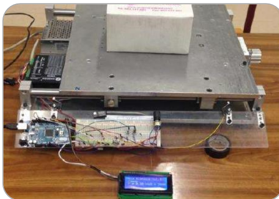
Figura 5. Construcción mesa sísmica unidireccional.
