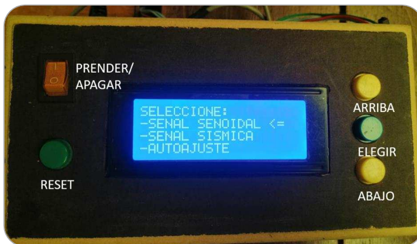
Figura 92. Componentes, interfaz del panel de control.
