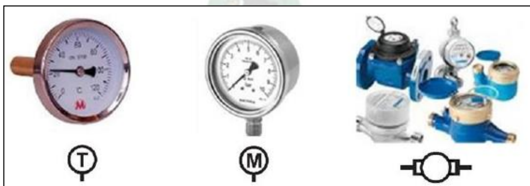
Figura 2.27: Termómetro, manómetro, caudalímetro y símbolos respectivamente.
