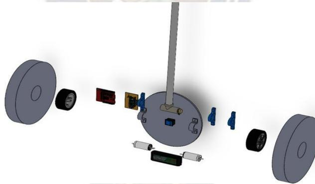
Figura 3. 4: Montaje de los componentes electrónicos al chasis
