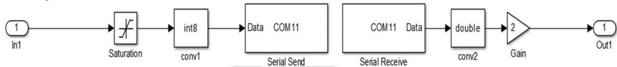
Figura 2. 36: Diagrama de bloques para la comunicación serial
