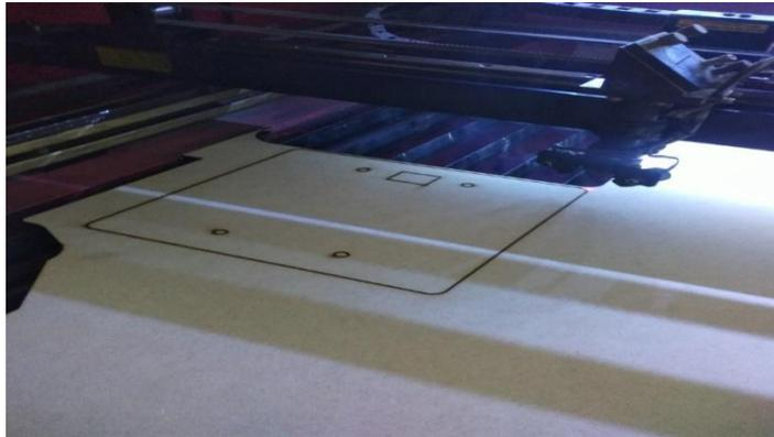
Figura 3. 2: Chasis del carro manufacturado con un equipo plasma.
