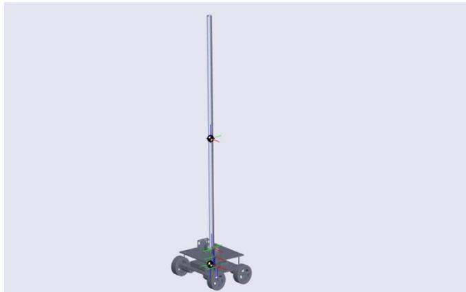
Figura 2. 24: Animación del péndulo invertido en Simulink.
