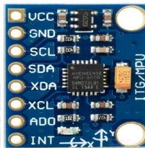
Figura 2. 11: Unidad de movimiento inercial MPU 6050
