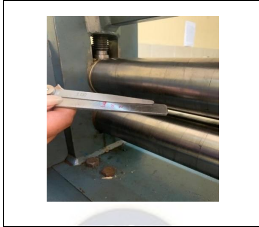
Figura 31.- Medición de la separación entre rodillos para 4.8 mm.
