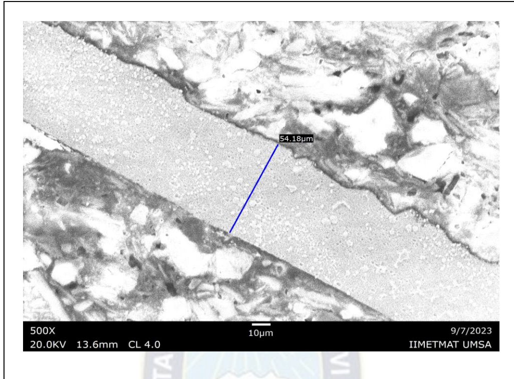
Figura 71.- Fotomicrografía SEM de foil final obtenido de la barra fundida de EM Bolivar en estado recocido.
