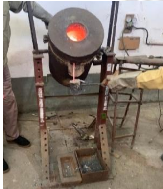
Colada del horno a cuchara de transferencia
