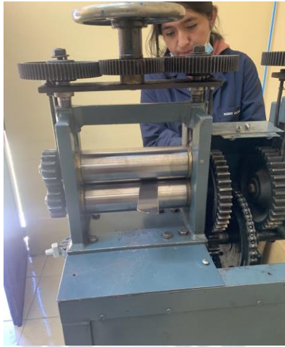
Pruebas de laminación con aluminio
