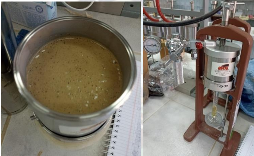
Figura 3.25. Montaje del equipo Filtro API con el lodo
