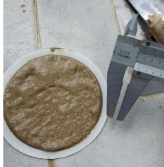
Figura G.1. Medición del espesor del revoque con vernier
