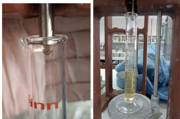
Figura 3.26. Obtención del filtrado en probeta de 10ml
