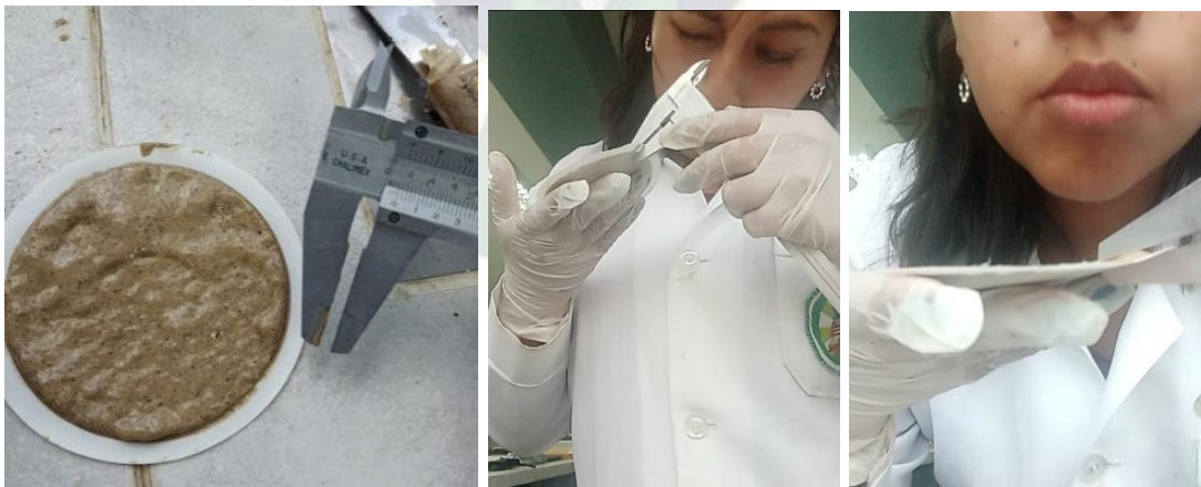
Figura 3.33. Medición del espesor del revoque con vernier
