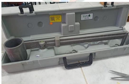
Figura 3.19. Calibración de la balanza de lodo con agua
