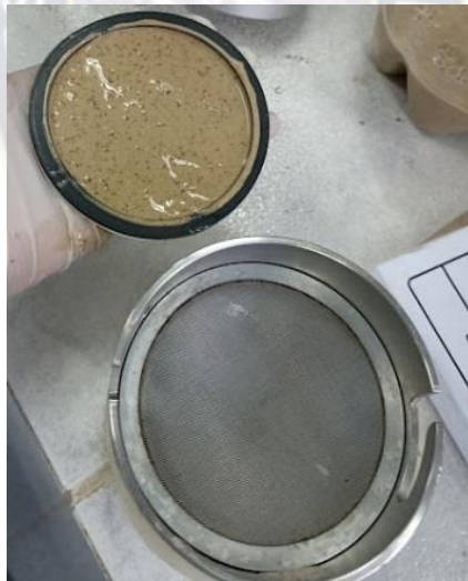
Figura 3.27. Extracción del revoque al desmontar
