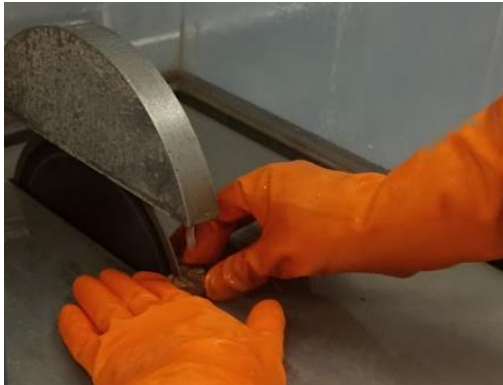
Figura 3.39. Cortado de muestras pequeñas
