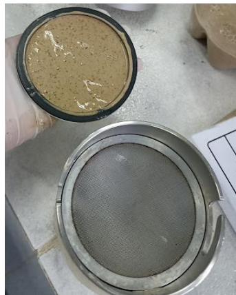
Figura F.3. Extracción del revoque al desmontar
