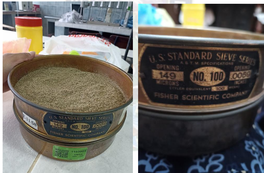
Figura 3.15. Tamizado de la chía en Malla 100
