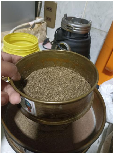
Figura 3.14. Tamizado de la chía en malla 40
