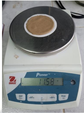
Figura 3.34. Pesaje del revoque húmedo
