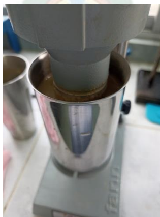
Figura 3.23. Medición de viscosidad del lodo en RPM
