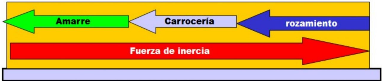
Figura 2. 7 Dispositivos de sujeción de equipos de trabajo y cargas diversas sobre vehículos de transporte: Seguridad
