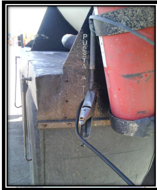
Figura 2. 12 Proceso de colocación de PAT
