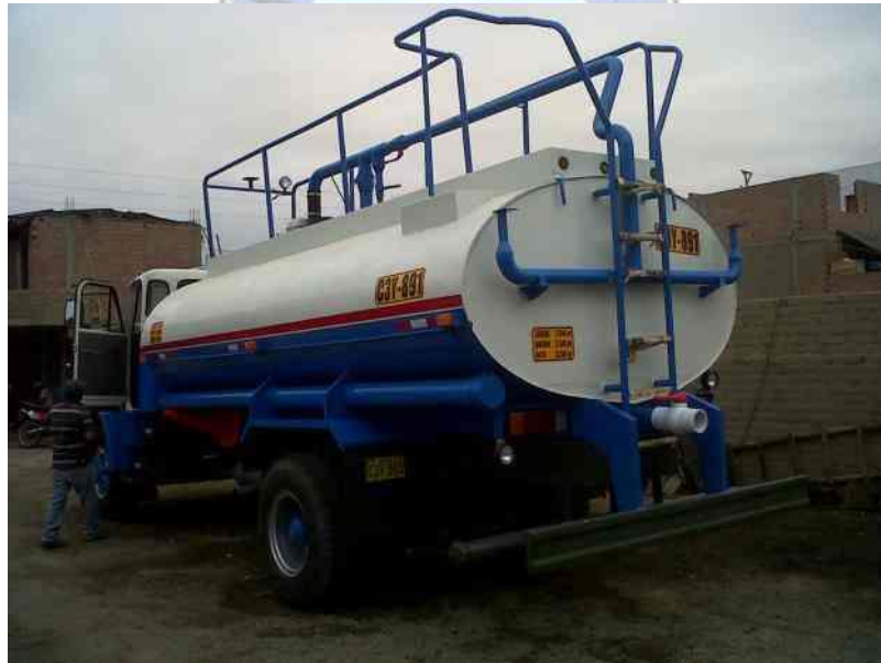
Figura 2. 2 Tanque cisterna con sistema de aspersión
